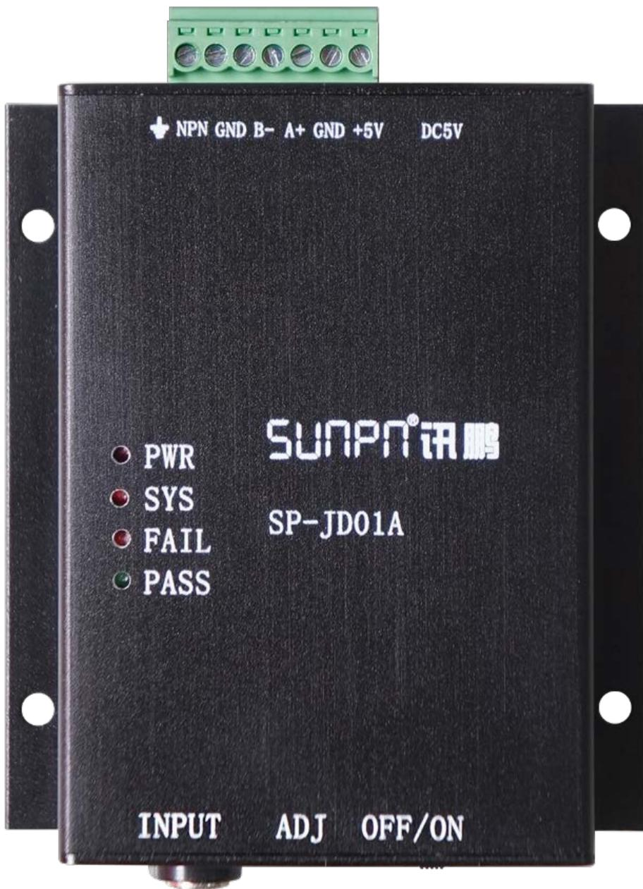
SP-JD01A静电手腕带监控仪能实时监测操作人员佩戴腕带的情况及地线接入大地是否良好，遇到异常状况立刻自动声光报警，可同时通过RS485通讯接口将报警信息传达给企业管理系统，便于在线监控、统计、处理，确保静电防护安全有效；监控仪内部专门增加了安全电源隔离电路，避免因外部电源故障对佩戴人员造成电击伤害。
